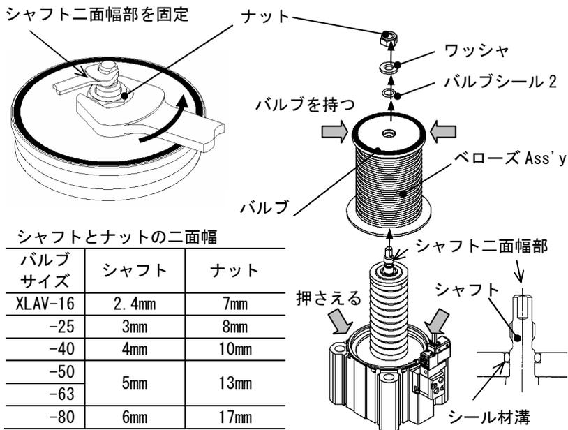
ポンネット Ass'y のシャフト二面幅部をスパナなどで押しさえ、ナットを取外してください。<バルブに傷を付けないようにご注意ください。>
