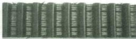
皮带齿低磨损(中心线漏出)
