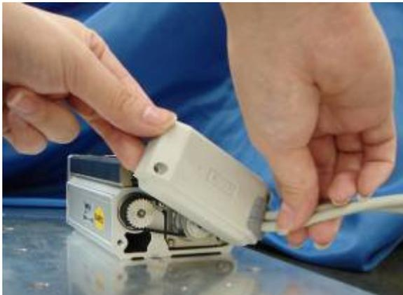
(3)把固定电机的螺钉拧松。完全卸下螺钉的话可能会丢失，只拧松一些即可。
