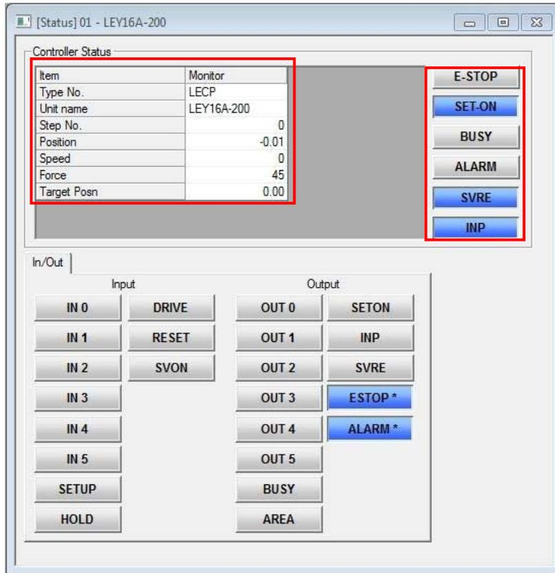
状态窗口显示例(电机控制器)
