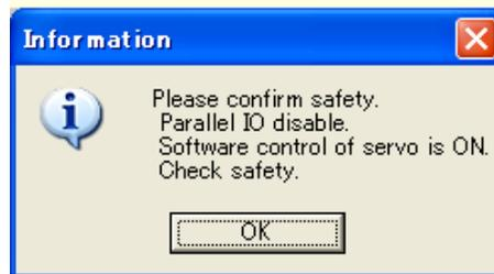
从测试模式向监控模式切换时，显示以下的注记。控制器的并联 I/O 有效，请加以注意。
