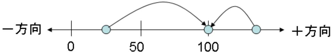
此例是通过绝对位置移动的方式移动到 100mm 位置的事例。此时无论台面位于何处都是向 100mm 的位置移动。
