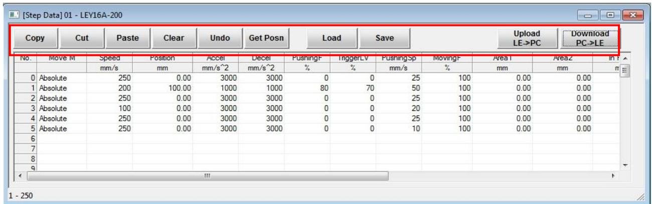
步骤数据窗口显示例(电机控制器)
