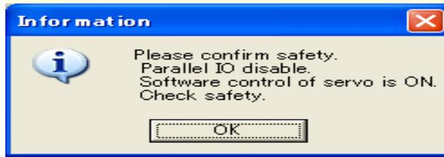
从测试模式向监控模式切换时，显示以下注记。控制器的并联 I/O 有效，请加以注意。
