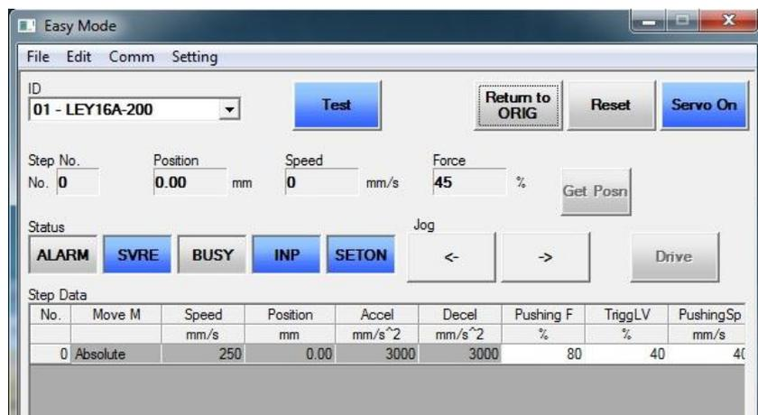
简易模式画面显示例(电机驱动器(脉冲输入型))
