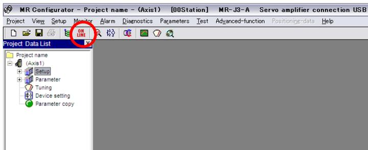
如果控制器无效（OFF LINE），请确认配线以及电源电压。
