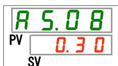
**15.** 按 [▲] 键和 [▼] 键从下表中选择循环液吐出压力的上限压力，按「SEL」键确定。
