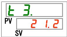
显示本产品的冷冻机吸入的温度。
