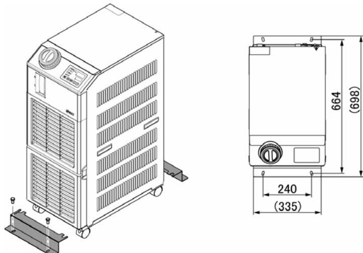
图 3-4 抗震托架的安装
