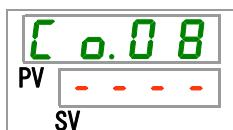
**16.**按〔▲〕键和〔▼〕键从下表中选择通信速度（简易通信协议），按〔SEL〕键确定。
