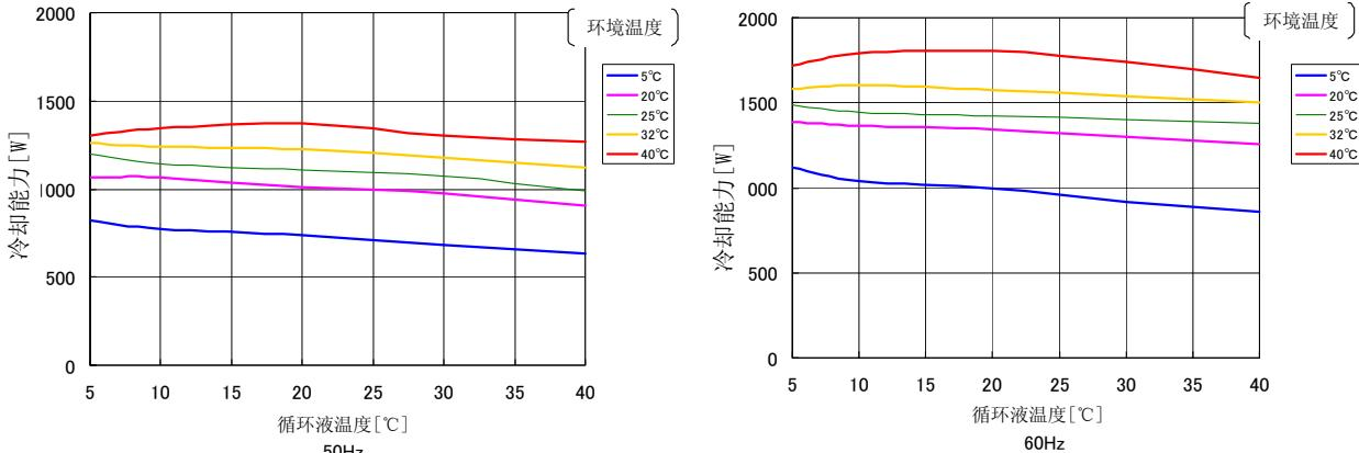
图 8-5 冷却能力 (HRS050-A-20-(BJM))
