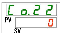
**44.**按〔▲〕键和〔▼〕键从下表中选择触点输入信号2 OFF 检测计时器，按「SEL」键确定。
