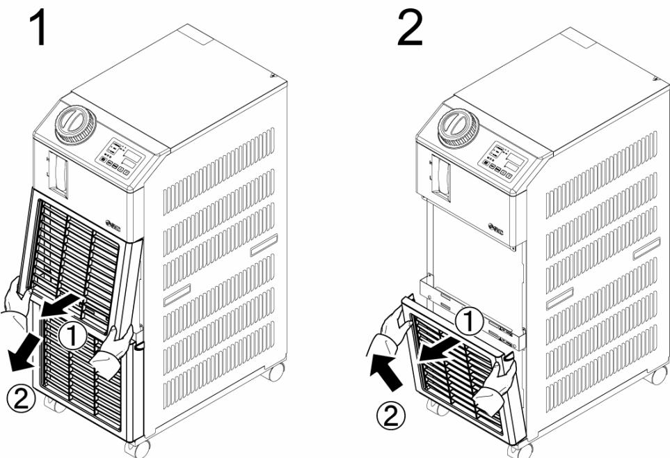
图 7-1 拆卸防尘过滤器
