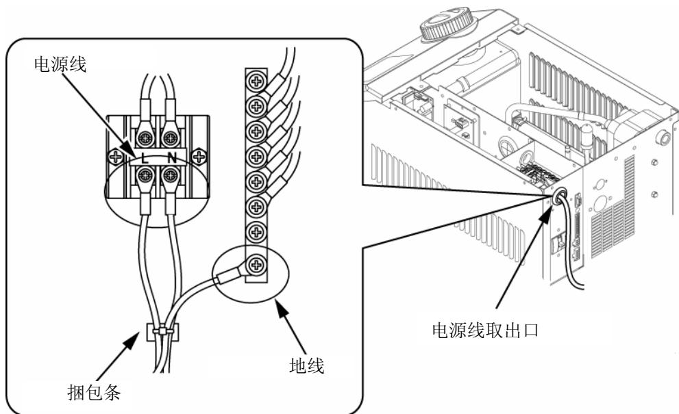
图 3-7 电线的配置图
