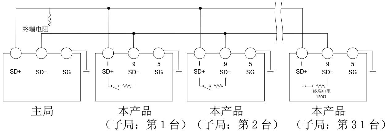
图 3-10 RS-485 通信连接方法
