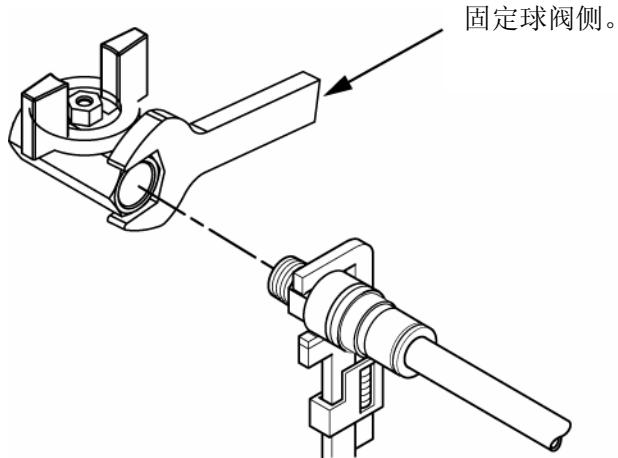
图 7-6 排水管的配管连接方法
