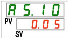
**19.**按 [▲] 键和 [▼] 键从下表中选择循环液吐出压力的下限压力，按「SEL」键确定。
