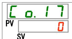
**34.**按〔▲〕键和〔▼〕键从下表中选择触点输入信号1读取延迟计时器时，按〔SEL〕键确定。
