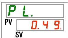
显示本产品的冷媒回路低压侧的压力。
