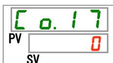
**34.**按 [▲] 键和 [▼] 键从下表中选择触点输入信号 1 读取延迟计时器时，按「SEL」键确定。
