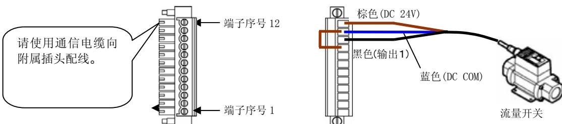
图 3-18 外部开关（PNP 开环集电极输出）的配线（例）
