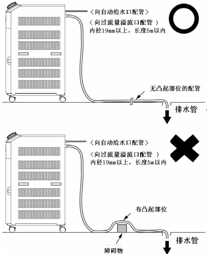
图 3-15 对自动给水口和过流量溢流口的配管
