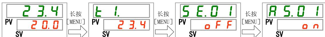
储液箱液面低下的切换 设定・确认
