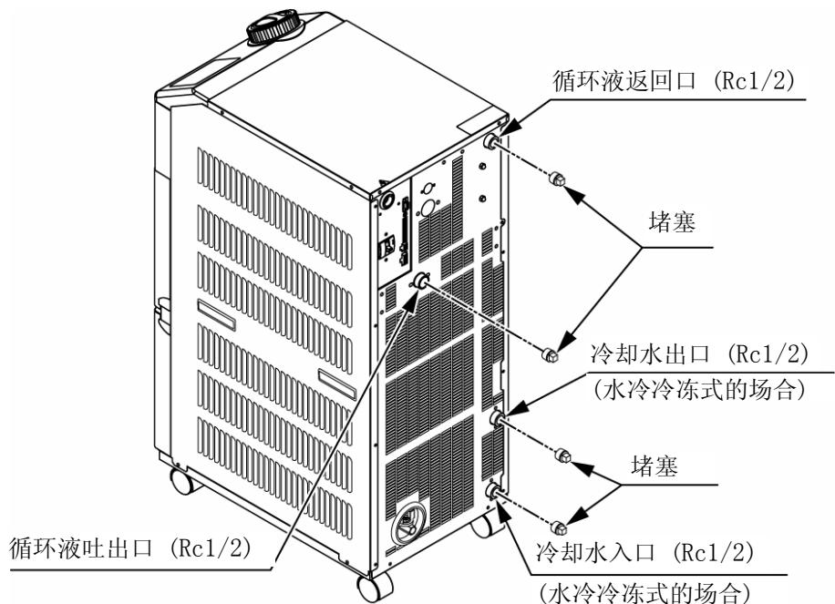
图 7-5 堵塞的安装
