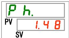
显示本产品的冷媒回路高压侧的压力。
