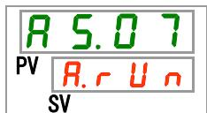
**13.** 按 [▲] 键和 [▼] 键从下表中选择循环液吐出压力超上限时的切换，按「SEL」键确定。
