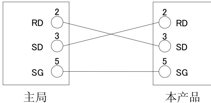
图 3-11 RS-232C 通信连接方法
