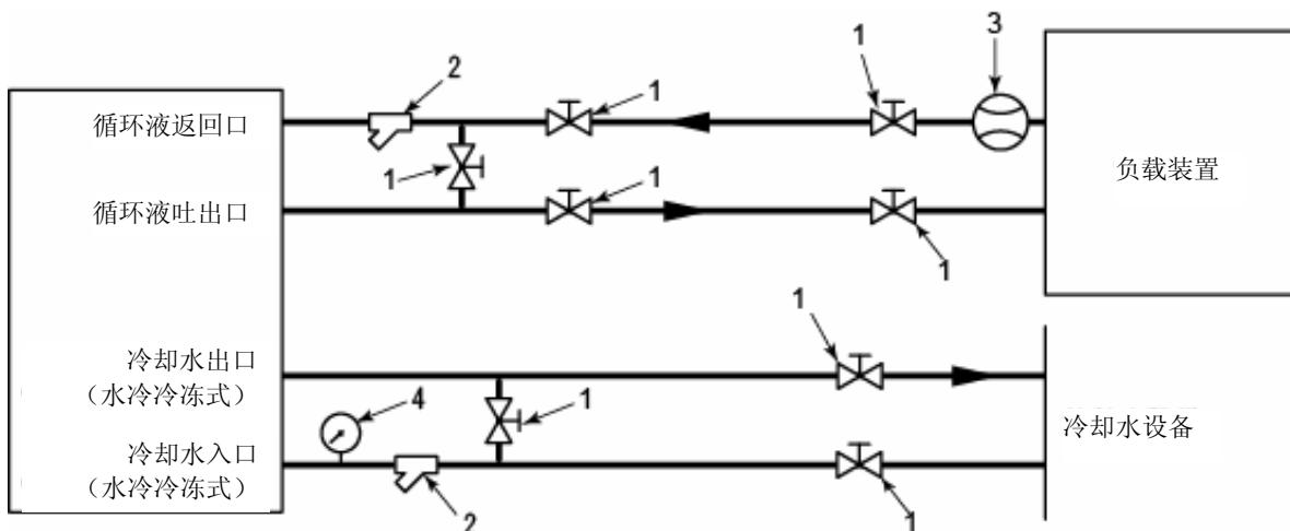
图 3-13 推荐配管回路
