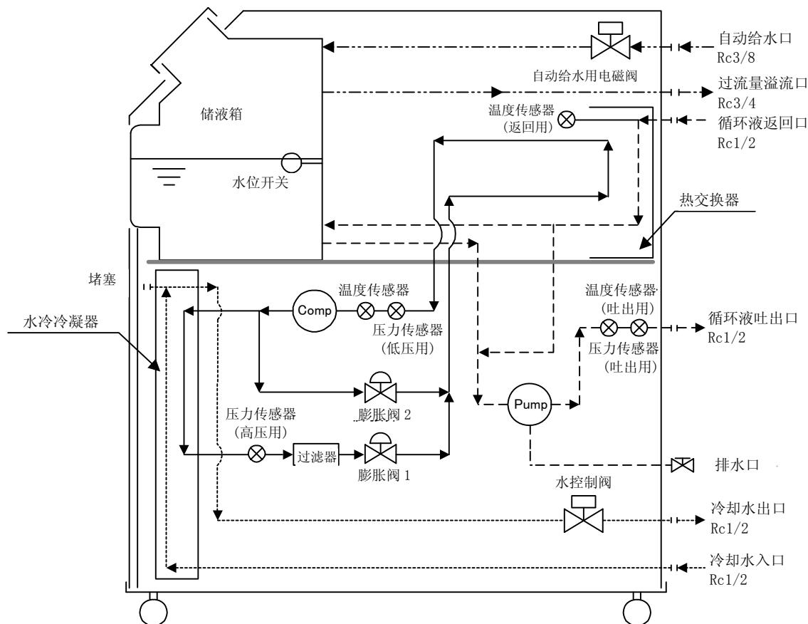
图 8-3 流程图 (HRS050-W※-20-(BJM))
