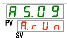
**17.**按〔▲〕键和〔▼〕键从下表中选择循环液吐出压力超下限时的切换，按「SEL」键确定。
