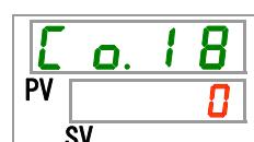
**36.**按〔▲〕键和〔▼〕键选择触点输入信号1 OFF 检测计时器，按「SEL」键确定。
