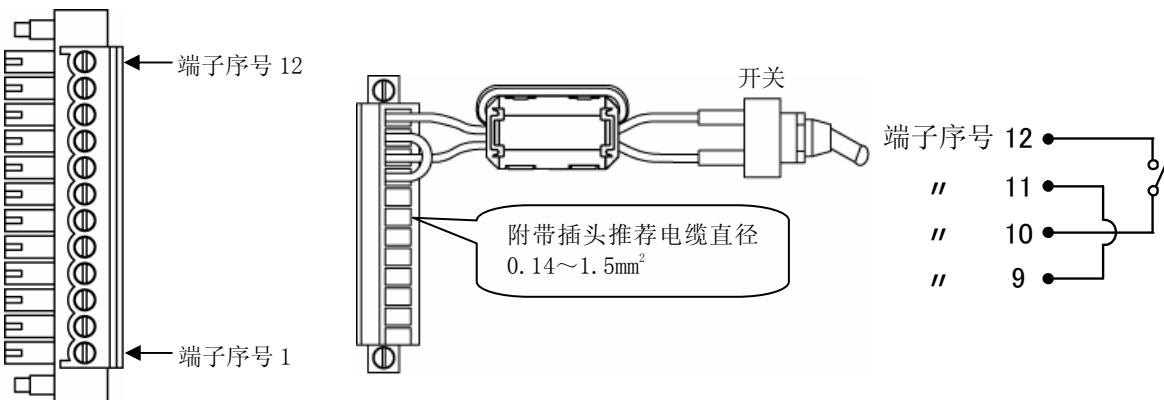
图 3-8 远程操作信号触点输入的配线（例）
