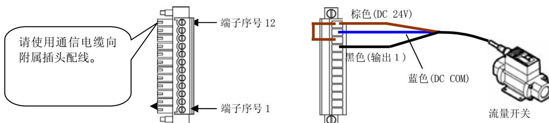
图 3-17 外部开关（NPN 开环集电极输出）的配线（例）
