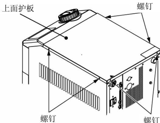
图 3-5 拆卸上面护板
