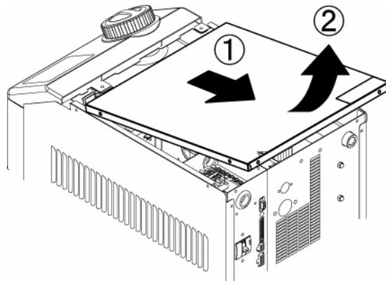
图 3-6 拆卸上面护板
