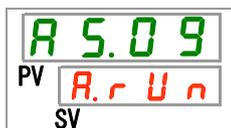
**17.**按 [▲] 键和 [▼] 键从下表中选择循环液吐出压力超下限时的切换，按「SEL」键确定。
