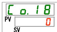
**10.** 按 [▲] 键及 [▼] 键从下表中选择触点输入信号 1 OFF 检出计时器，按「SEL」键确定。
