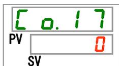
**8.** 按 [▲] 键及 [▼] 键从下表中选择触点输入信号 1 读取延迟计时器时，按「SEL」键确定。
