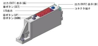
出力(OUT1)表示(緑): スイッチ出力 OUT1 が ON 時に点灯します。 出力(OUT2)表示(赤):供給用パイロット弁信号がON時に点灯します。 LED 表示:現在の圧力状態、設定モードの状態、エラーコードを表示します。 △ボタン(UP): モードの選択および ON/OFF 設定値を増加させます。 ピーク表示モードへの切換えに使用します。
