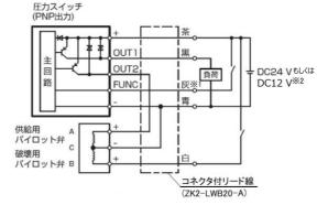
※1 供給弁を省エネ動作(ワークを吸着)させるとき、N.C.仕様(バルブタイプ K)の場合は灰色線 (FUNC)に通電し、N.O.仕様(バルブタイプ E)の場合は灰色線(FUNC)を非通電にします。 ※2 バルブの定格雷圧と同じ雷圧を印加してください
