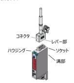
付属の O リングを圧力スイッチの O リング溝に装着して、付属の取付ねじ 2 本でエジェクタ本体に 取付けてください。(適正締付トルク: 0.08~0.10 N·m) 過大な締付トルクをかけると、取付部が変形、破損する恐れがあります。
