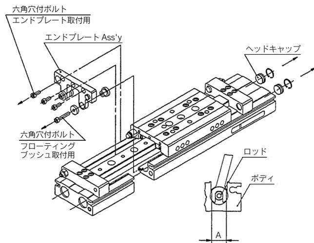
注) フローティングブッシュ取付、取外しの際はボディ内面に傷等付けぬよう幅がA寸法となるようなスパナを用い十分に注意して行うこと。
