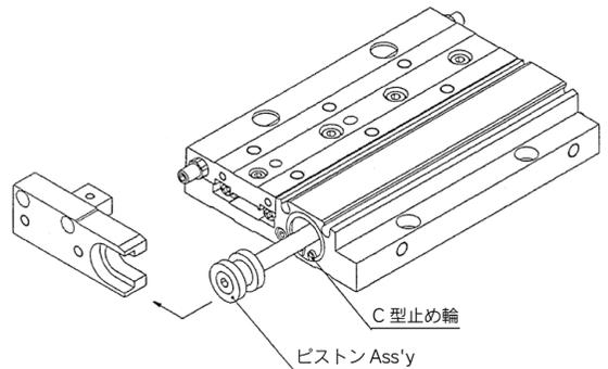
③C型止め輪を止め輪工具を用いて外す。
