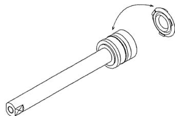
⑦ピストンロッドを挿入し以下逆の手順にて組立てる。
