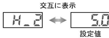
**Ⓢ** ボタンを押して設定 **▼** 供給用パイロット弁信号ON点の設定に移ります。
