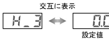
**Ⓢ** ボタンを押して設定 **▼** 供給用パイロット弁信号OFF点の入力禁止範囲の設定に移ります。
