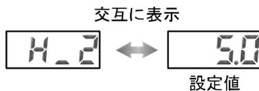
**S**ボタンを押して設定 ↓ 供給用パイロット弁信号OFF点の設定に移ります。
