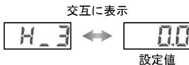
**S**ボタンを押して設定 ↓ 供給用パイロット弁信号ON点の入力禁止範囲の設定に移ります。
