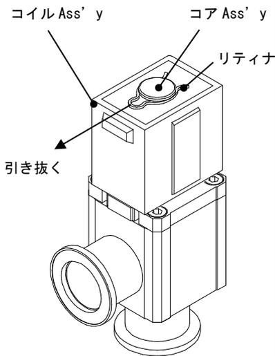
コイル Ass'y を下方方向に押付けた状態で、リティナを横方向に引き抜いてください。
