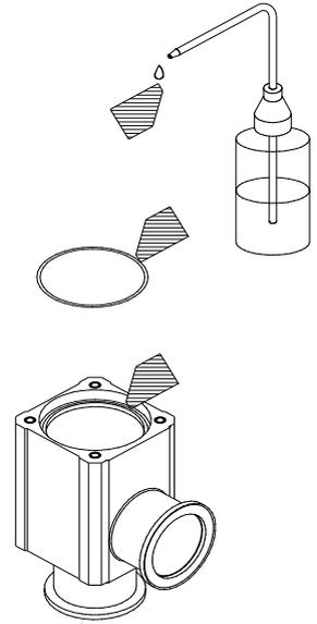
クリーン対応の布(ベンコットなど)にエタノールを塗布してOリング表面とボディ取付け面のゴミを拭き取ってください。拭き取り後、Oリングを装着してください。
