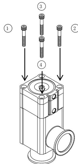
六角穴付ボルトを番号順に締めます。締めは、初め手締めでOリングをつぶす手前まで均一に締め、最後に全体の増締めを行えば完了です。
