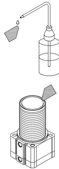
クリーン対応の布(ベンコットなど)にエタノールを塗布してOリング溝部内のゴミを拭き取ってください。
