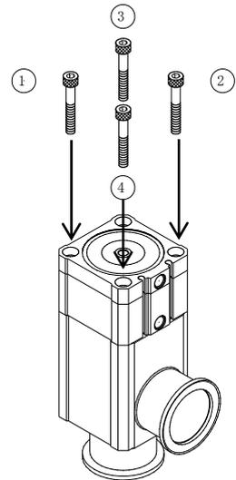
六角穴付ボルトを番号順に締めます。締めは、初め手締めでOリングをつぶす手前まで均一に締め、最後に全体の増締めを行えば完了です。
