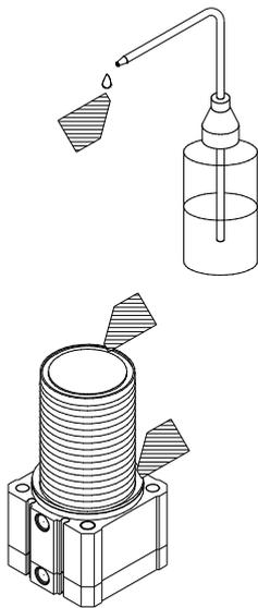
クリーン対応の布(ベンコットなど)にエタノールを塗布してOリング表面とOリングシート面のゴミを拭き取ってください。
