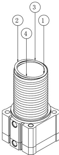
クリーン対応の布(ベンコットなど)にエタノールを塗布してOリング表面のゴミを拭き取りOリング溝にのせます。番号順(対角となるように)にOリングを押し溝の中にOリングを装着します。(無発塵手袋を使用してください。)
