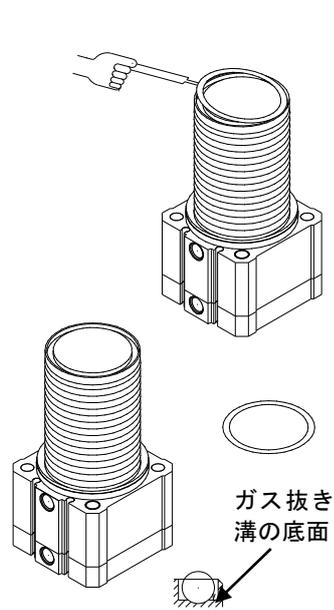
Oリング溝のガス抜き溝部から、ガス抜き部の底面と同じ高さの工具によりOリングを溝から取出してください。
