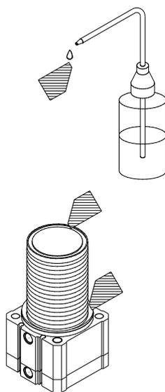
クリーン対応の布(ベンコットなど)にエタノールを塗布してOリング表面のゴミを拭き取ってください。
