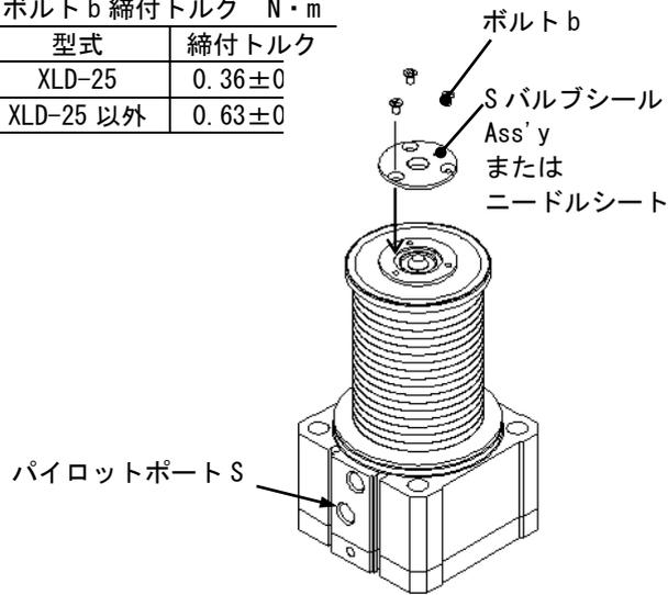
パイロットポート S に 0.3MPa の空気圧を加え、ニードルシートまたは S バルブシール Ass'y を置き、ボルト b を締め付け固定します。ボルト b の締め込みは、初め手締めで Oリングを潰す直前まで全体を締め付け、順に増し締めを行ってください。
