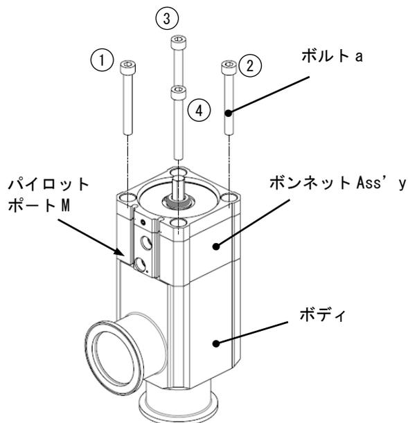
パイロットポート M に 0.2MPa の空気圧を加え、ボルト a を番号順に緩めてボディとボンネット Ass'y を分解してください。
