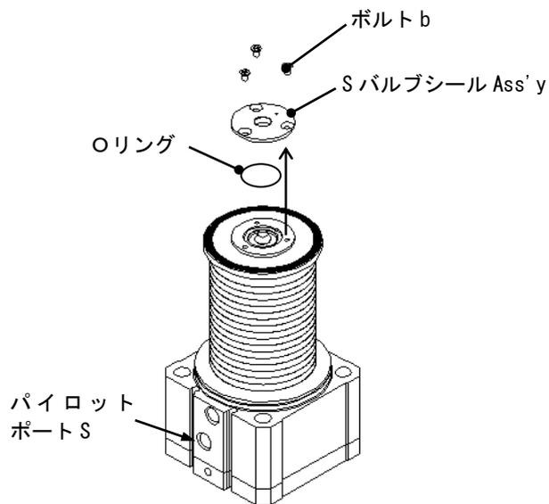
パイロットポート S に 0.3MPa の空気圧を加え、ボルト b を緩めて S バルブシール Ass'y を取外します。サイズ 25, 40, 50, 160 では初期排気弁部シール Oリングも取外します。
