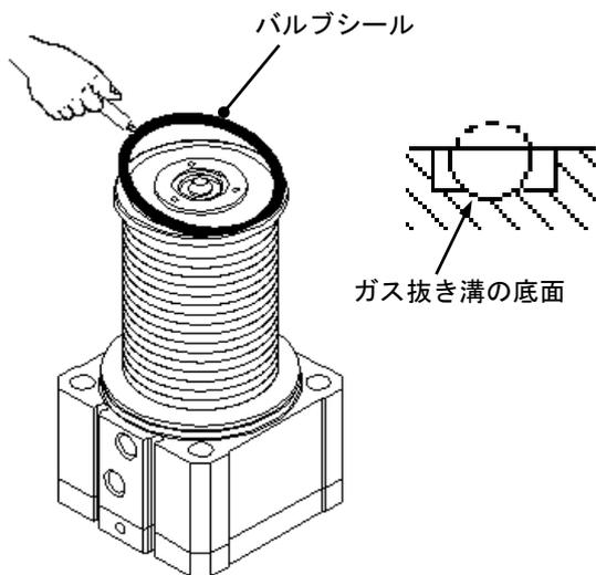
シール材溝のガス抜き溝部の隙間を利用し、バルブシールを取出してください。取出す際は、プラスチックなどの工具を使用し、シール材溝に傷をつけないようにご注意ください。
