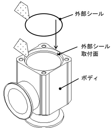
外部シール表面およびボディの外部シール取付面のゴミを拭き取り、外部シールを外部シール取付面に置きます。
