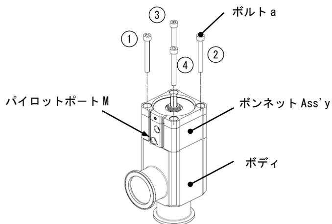
パイロットポート M (主排気用) に 0.2MPa の空気圧を加え、ボルト a を番号順に締め付けてボディとボンネット Ass'y を組付けてください。ボルト a の締め込みは、初め手締めで外部シールを潰す直前まで全体を締め付け、番号順 (対角となるように) に増し締めを行ってください。
