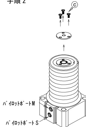
パイロットポート S (初期排気用) に空気圧 0.3MPa を加えて、Sバルブシール ASS' Y 固定用ネジ c を緩め、Sバルブシール ASS' Y を取り外して下さい。
