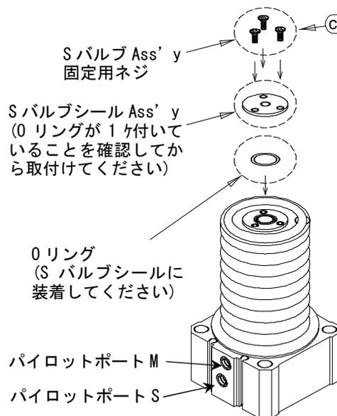
パイロットポート S (初期排気用) に空気圧 0.3MPa を加えた状態で Oリングを装着した Sバルブシール Ass' y を取り付けて下さい。次に Sバルブシール Ass' y 固定用ネジ c を締め込んで下さい。締め込みは、初め手締めで Oリングを潰す前まで全体を締めおきます。最後に全体の増締めを行えば完了です。
