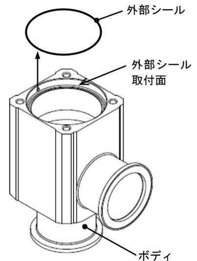
ボディから外部シールを取外してください。＜外部シール取付面に傷を付けないようにご注意ください。＞
