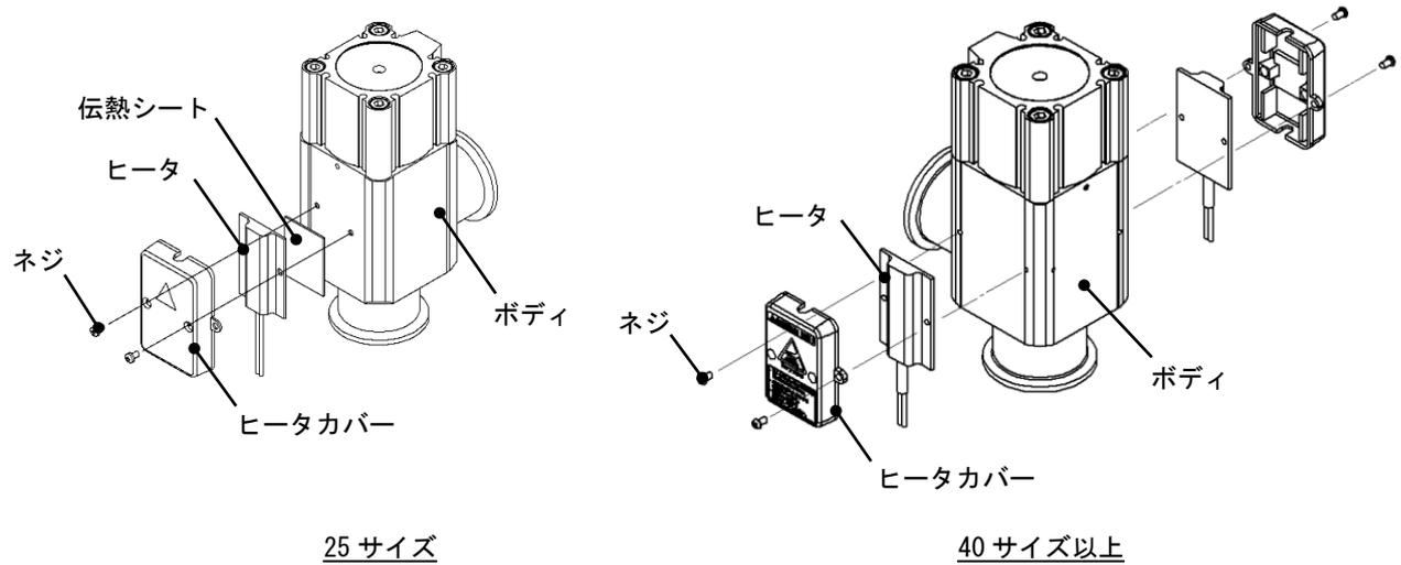
ボディ側面に伝熱シート（注1）、ヒータ、ヒータカバーをセットします。
