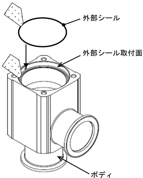
外部シール表面およびボディの外部シール取付面のゴミを拭き取り、外部シールを取付面に置きます。
