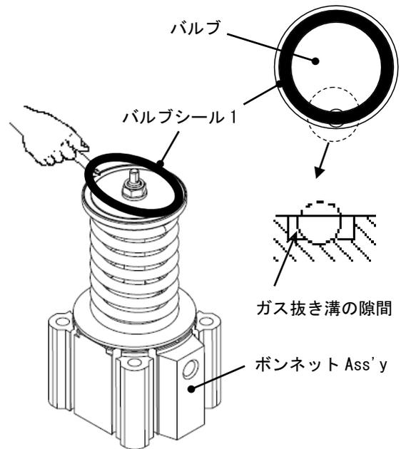
バルブのシール材溝のガス抜き溝部の隙間を利用し、バルブシール1 を取出してください。取出す際は、プラスチックなどの工具を使用し、シール材溝に傷を付けないようにご注意ください。
