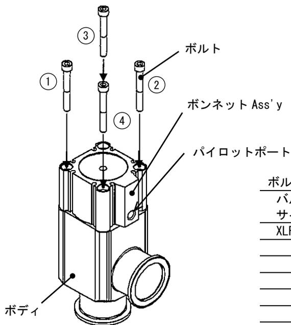
ボルトサイズ、推奨工具、および締付トルク N・m
