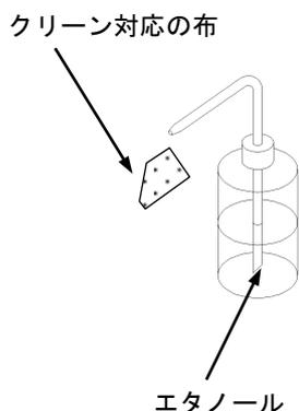
組付けは各部のゴミを取除きながら行ないます。ゴミはエタノールを浸したクリーン対応の布で拭取ってください。必要に応じてクリーンエアによるエアブローを行ってください。<糸くず、埃などが全く無いことを確認してください。>
