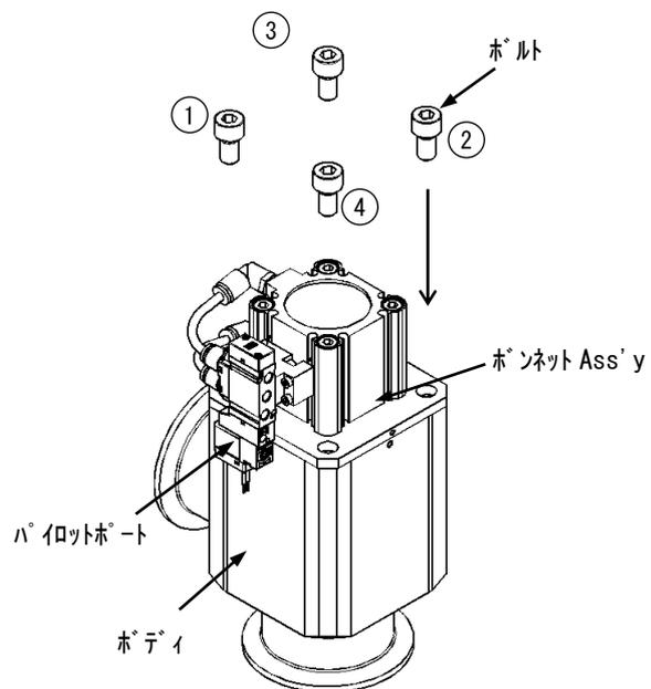
パイロットポートに 0.4MPa の空気圧を加え、ボルトを番号順に締付てボディとボーンネット Ass'y を組付けてください。ボルトの締込みは、初め手締めでOリングを潰す直前まで全体を締付け、番号順（対角となるように）に増締めを行ってください。
