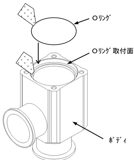
外部シールOリング表面及びボディのOリング取付面のゴミを拭取り、OリングをOリング取付面に置きます。
