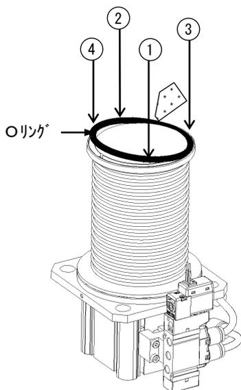
バルブシールOリング表面のゴミを拭取り、Oリング溝の上に置きます。番号順（対角になるように）にOリングを押して溝の中にOリングを装着します。Oリングが振れないようにご注意ください。<無塵手袋を使用して下さい。>
