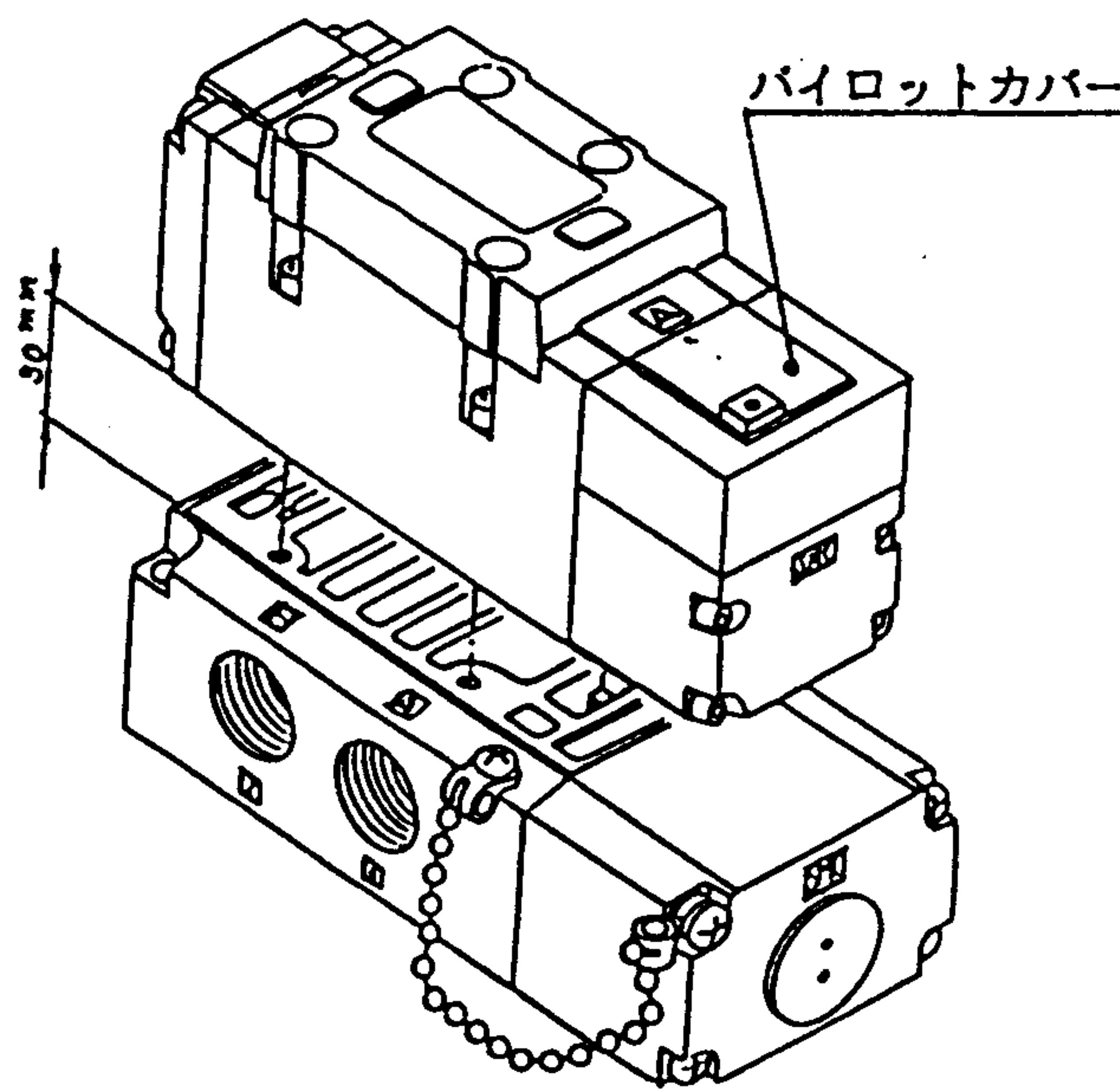
・取り付けボルト(4-M8×80)をゆるめた後、電磁弁本体をまっすぐに引き抜いて下さい。斜めに引き抜きますと思わぬトラブルの原因となりますので、御注意下さい。
