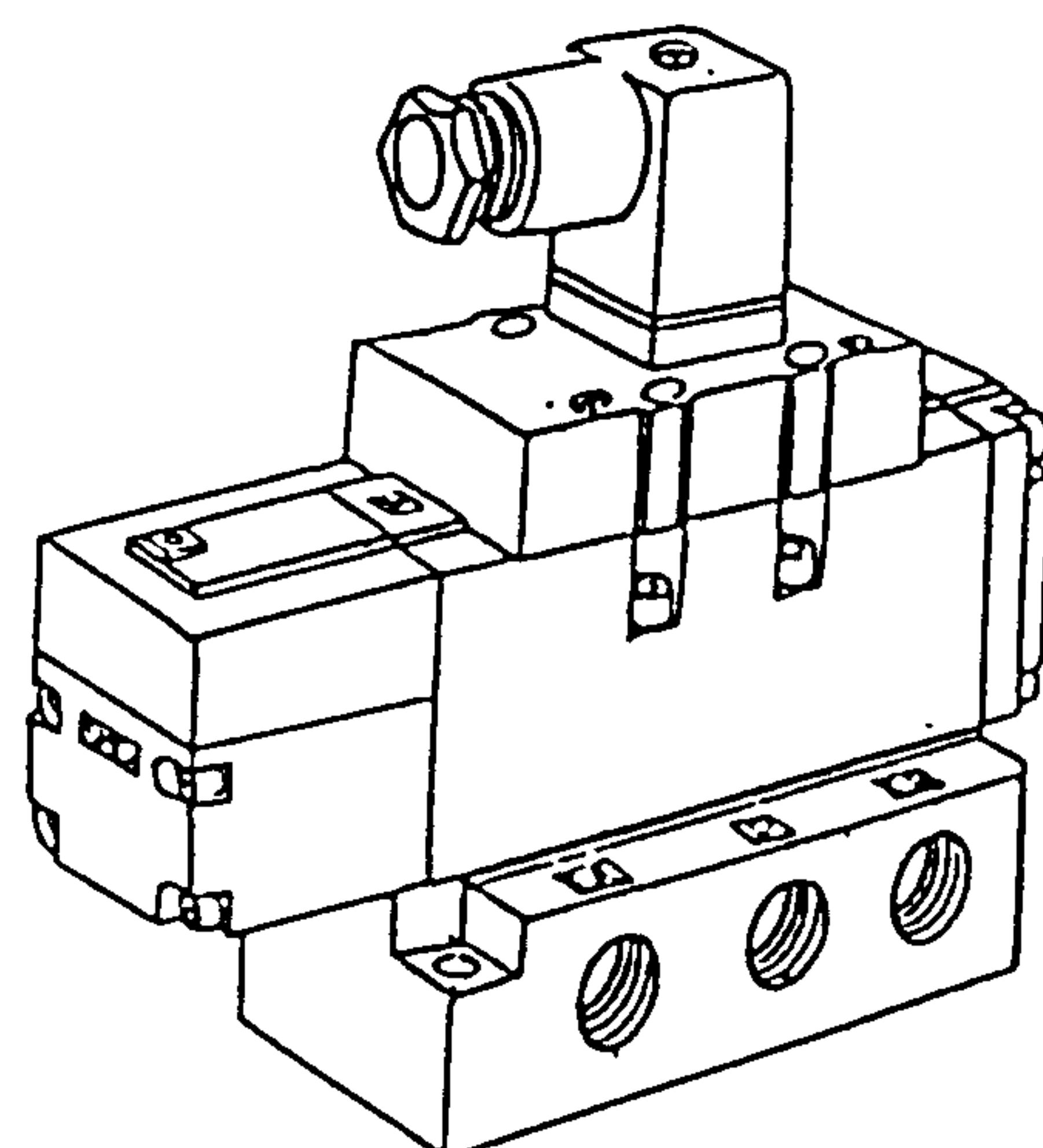
・DIN形端子台のオスピン端子には、ソレノイドと次のように内部結線されておりますので、各々に対応するコネクタ部の端子台に結線をして下さい。
