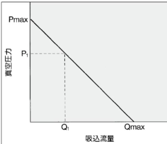
流量特性は、エジェクタの真空圧力と吸込流量の関係を表し、吸込流量が変化すると真空圧力も変化することを示しています。一般には、エジェクタの標準供給圧力での関係を示しています。図で、Pmax は最高真空圧力、Qmax は最大吸込流量を示しています。カタログ等で仕様として掲載されている値はこの値です。真空圧力の変化のしかたについて、順を追って説明します。
