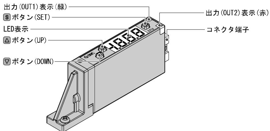
出力(OUT1)表示(緑)：スイッチ出力 OUT1 が ON 時に点灯します。
