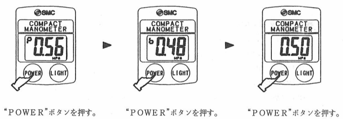
①“POWER”+“LIGHT”ボタンを3秒以上押し続ける。 ②“LIGHT”ボタンを押す。 ③“POWER”ボタンを押す。
