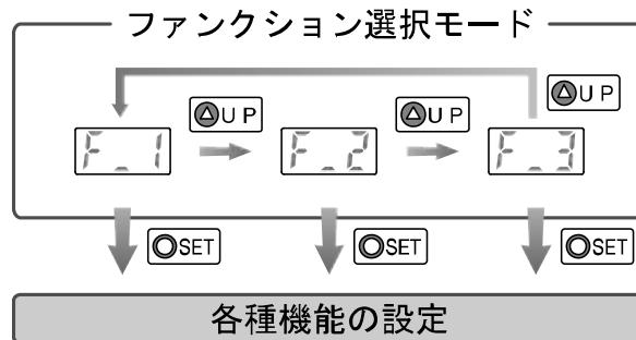
※：初期設定モードの出力モードの選択で、OUT1、OUT2 いずれかを瞬時出力モードにした場合、[F\_1] と [F\_2] が表示されます。
