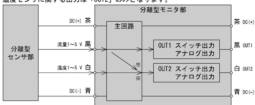
※：設定により OUT2 の出力を、温度に対する出力/流量に対する出力のいずれかを選択できます。
