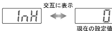
※：初期設定モードのスイッチ動作の選択で非反転出力を選択した場合は、[1PH]が表示されます。
