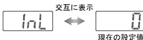
※：初期設定モードのスイッチ動作の選択で非反転出力を選択した場合は、[1PL]が表示されます。
