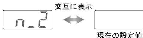
※：初期設定モードのスイッチ動作の選択で非反転出力を選択した場合は、[P\_2]が表示されます。
