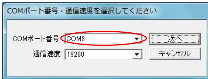
\*下記のように「COMポート取得不可」と表示される場合や通信ケーブルを接続した COM ポート番号が表示されない場合は、通信ケーブルが認識されていません。配線及び 2 つのドライバが正常に組み込まれている事を確認してください(詳細は「3. 通信ポートの確認」を参照ください)。
