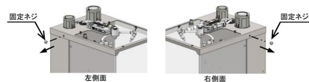
②トップカバー-Ass'y を持ち上げながら、サイドカバーを下図のようにスライドさせて取り出します。トップカバー-Ass'y は配管・配線が本体と接続しているため、必要以上に持ち上げないようにご注意ください。
