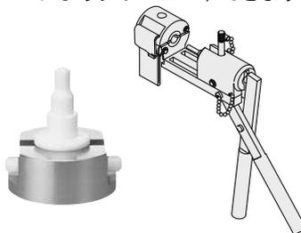
②ナットは、ボディ端面までねじ込み、さらにボディ端面まで突当たった事を確認するため、目安としてさらに1/8回転締付けてください。なおナットが回らなければ締付けが十分な状態です。また下記適正締付トルクをご参照ください。
