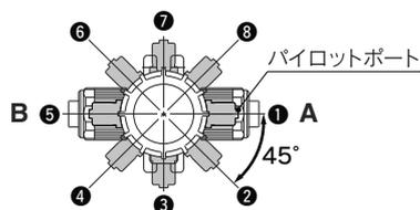
※手配時に配管方向を品番で指定してください。パイロットポートの方向変更は行わないでください。(P.5使用上の注意事項参照)
