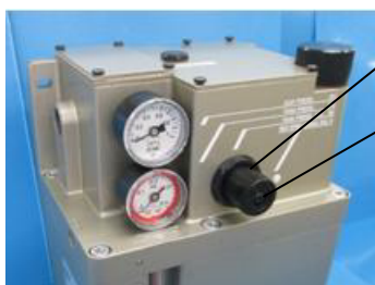
タンク圧力設定用減圧弁ハンドル
