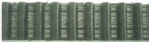
ベルト歯底摩耗（心線露出）
