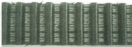
ベルト歯底摩耗（心線露出）
