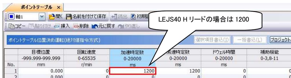
\*4: 原点復帰の加速時定数(msec)はポイントテーブル番号 1 の加速時定数を使用します。上図の箇所推奨値を設定してください。ポイントテーブルの設定方法は、『LECSB2-T□ 取扱説明書(簡易版)5.7 章』を参照してください。
