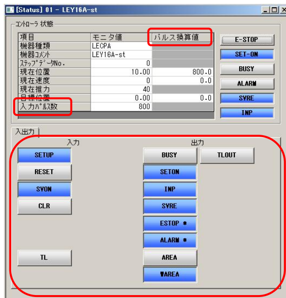
モータドライバ(パルス入力タイプ) (Normal モード画面例)
