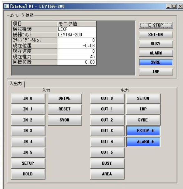
モータコントローラ (Normal モード画面例)
