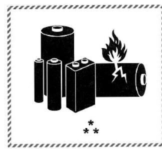
*国連番号の場所 **追加情報の電話番号の場所 図付.2 電池イラスト入り取扱いラベル例 (2017年1月1日から使用可能)
