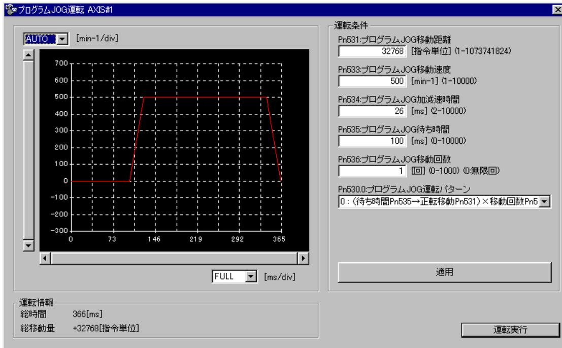
3. 運転条件を設定して、「適用」をクリックすると、運転パターンがグラフに表示されます。
