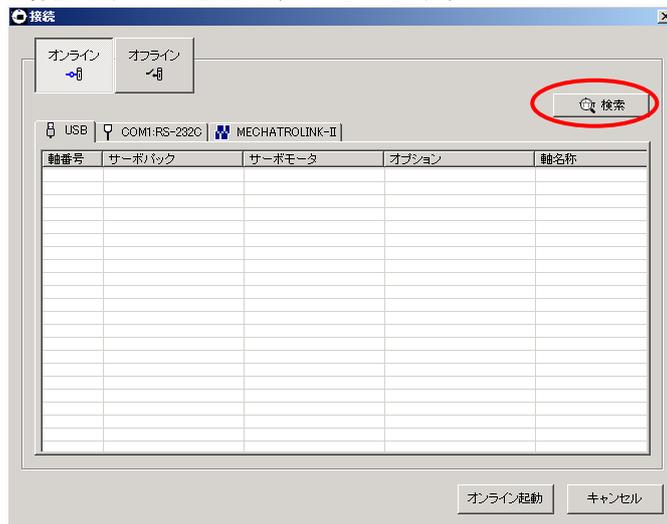
通信インターフェースを介して SigmaWin+ とドライバが通信するための設定を行います。
