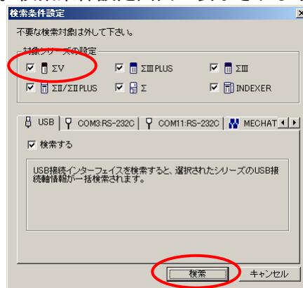
2.  $\Sigma V$  シリーズを設定して、「検索」をクリックします。接続可能なドライバが、通信インターフェースを介して検索され、接続画面に検索結果が表示されます。
