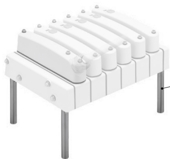
マウンティングレグ(M6) 締付トルク：4.9N・m
