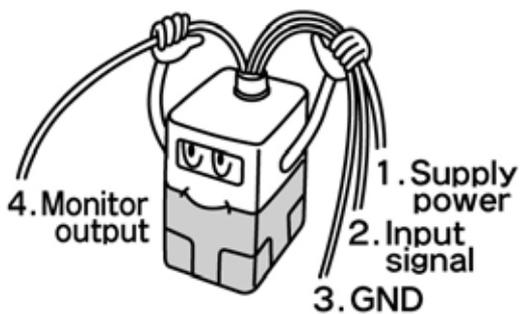
オプションの電源ケーブルコネクタは4芯線です。モニタ出力（スイッチ出力）を使用されない場合は誤動作の原因となりますので他の線などと接触しないように処理してください。
