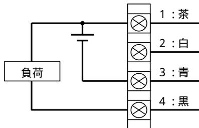
約 150mA DC 以上流しますと、過電流検出回路が作動し、「Er.5」を表示し、動作が停止します。
