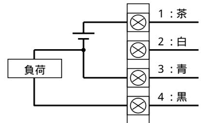
約 150mA DC 以上流しますと、過電流検出回路が作動し、「Er.5」を表示し、動作が停止します。
