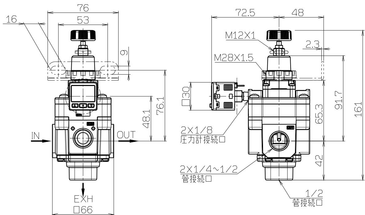
8-2. 排気方向が正面または背面仕様の外形寸法 [IR32\*(1、2)-A]
