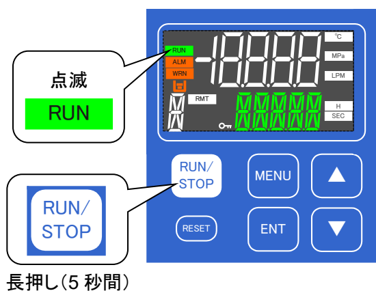
図 4-4 アラーム発生時の運転再開
