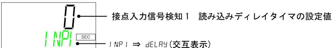
運転開始後、接点入力信号1の検知開始時間(sec)を設定することができます。
