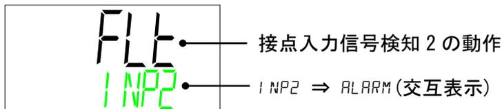
アラーム「AL26：接点入力信号検知 2」発生時の動作を選択することができます。
