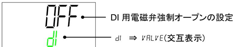
運転停止中に DI 用電磁弁を開けたい場合、[ENT]キーを押します。点滅表示になった後、
