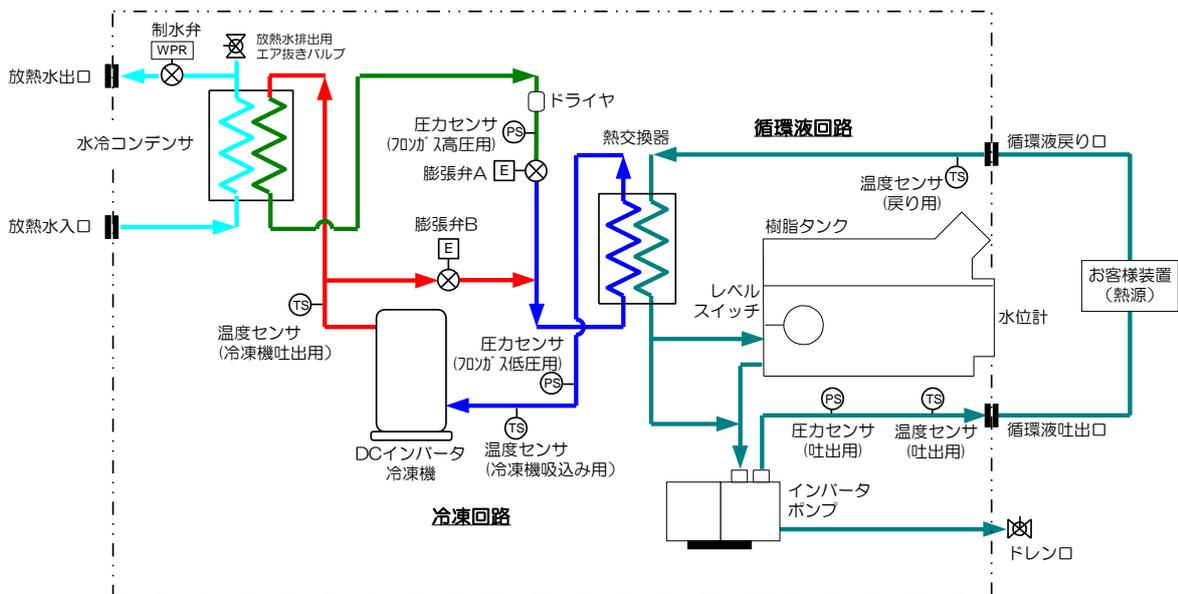
図 9-6 フロー図(HRSH090-W※-20/40-※)
