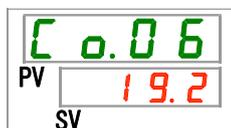
12. [▲]キー及び[▼]キーで下表から通信速度(MODBUS)を選択し「SEL」キーで確定してください。
