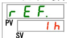
本製品の冷凍機動作積算時間を表示します。表示は表 5.5-2 を参照してください。冷凍機動作積算時間が 30,000 時間 (30 h h) 以上になった場合に AL30 冷凍機メンテナンスのアラームが発生します (A.RUN 設定時)。詳細は 6 章を参照ください。
