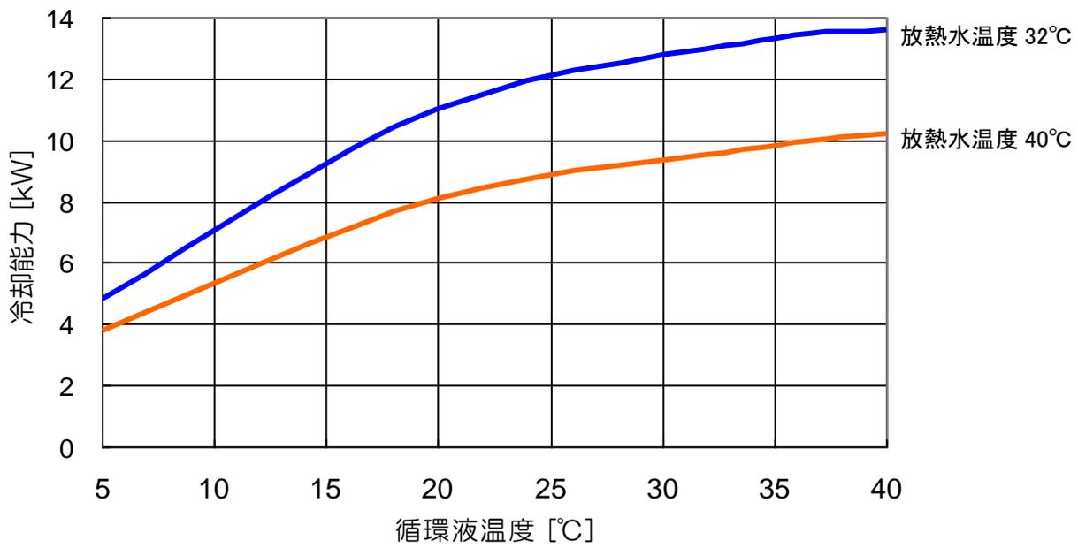
図 9-9 冷却能力(HRSH090-W※-20-※、HRSH090-W※-40-※)
