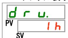
本製品の運転積算時間を表示します。表示は表 5.5-2 を参照してください。
