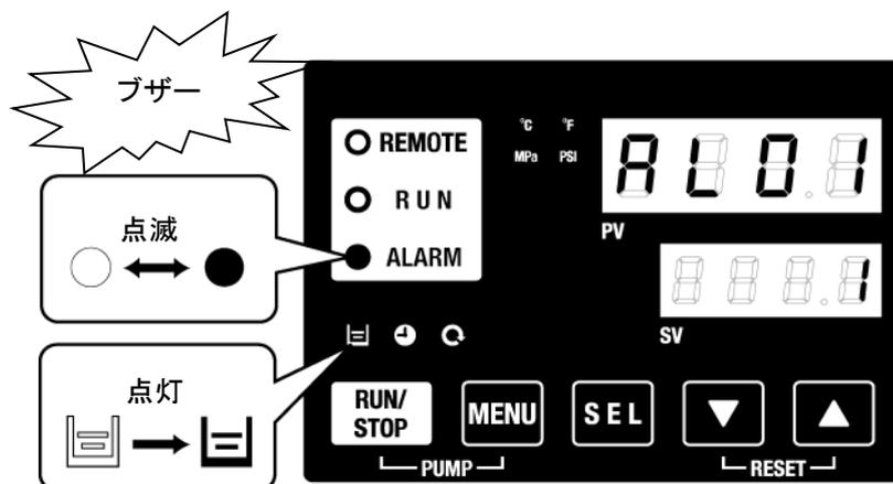
※AL01 タンク液面低下の場合のみ[≡]ランプが点灯します。
