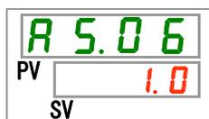
**11.** [▲]キー及び[▼]キーで循環液吐出温度低下の検出温度を設定し「SEL」キーで確定してください。
