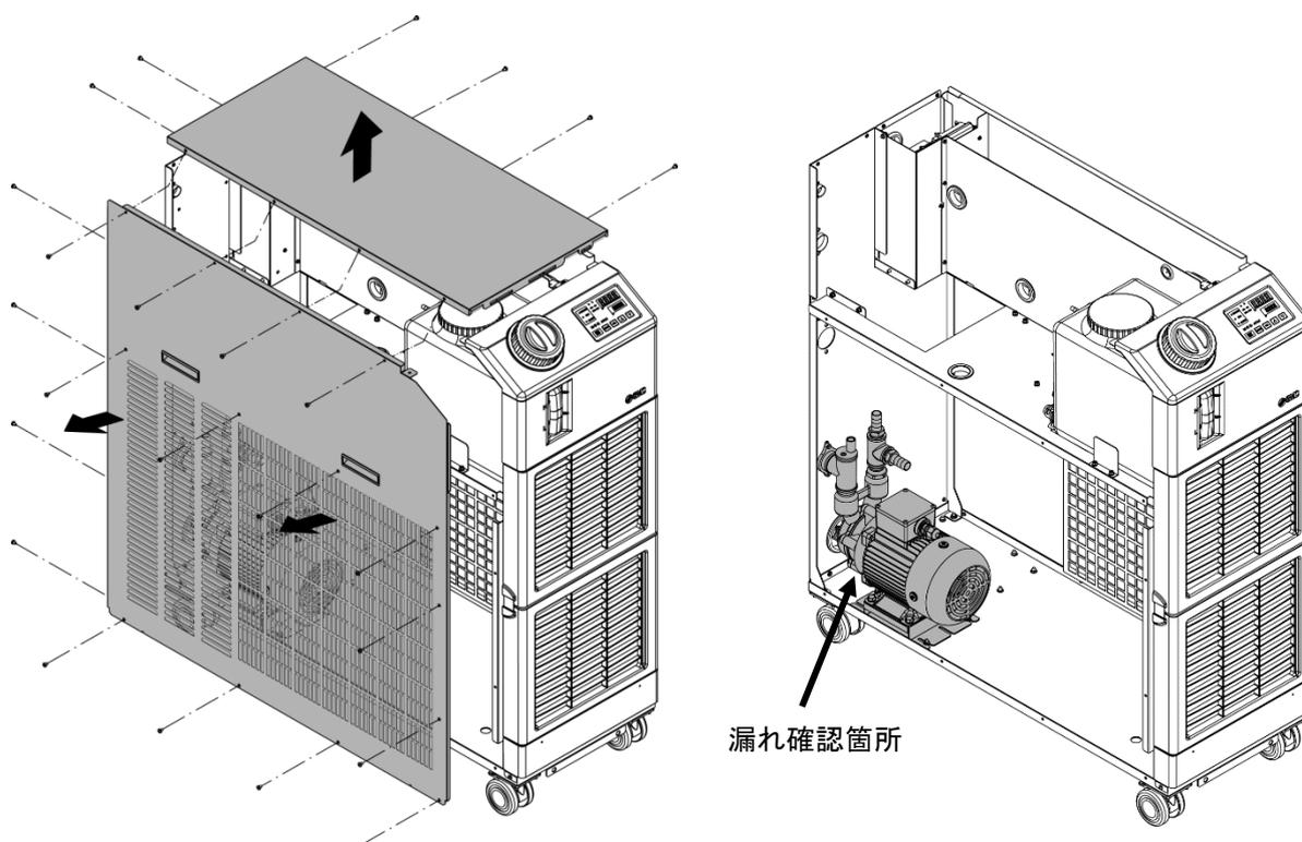
図 8-3 ポンプからの水漏れ点検
