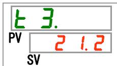
本製品の冷凍機吸込の温度を表示します。
