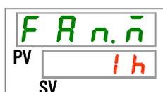
本製品のファン動作積算時間を表示します。表示は表 5.5-2 を参照してください。ファンモータ動作積算時間が 30,000 時間 (30 h h) 以上になった場合に AL29 ファンメンテナンスのアラームが発生します (A.RUN 設定時)。詳細は 7 章を参照ください。
