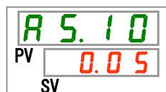
**19.** [▲]キー及び[▼]キーで循環液吐出圧力低下の検出圧力を設定し「SEL」キーで確定してください。
