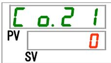
42. [▲]キー及び[▼]キーで下表から接点入力信号2読み込みデレータイマの時間を設定し「SEL」キーで確定してください。
