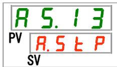
25.[▲]キー及び[▼]キーで下表から接点入力信号1検知の切り換えを選択し「SEL」キーで確定してください。
