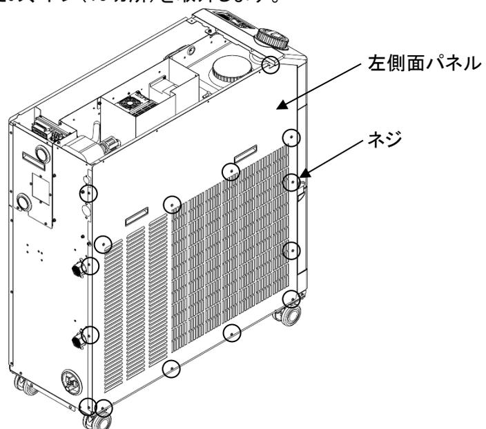
図 7-5 左側面パネル取外し
