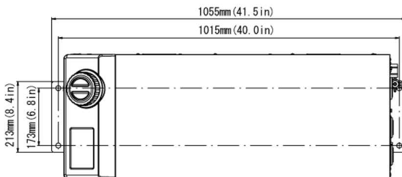
図 9-2 アンカーボルト取り付け位置
