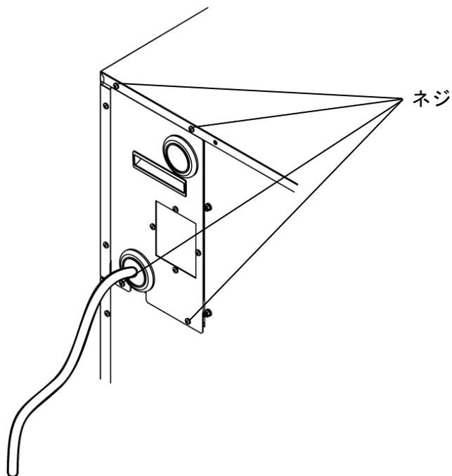
図 3-12 電源端子カバー取付け
