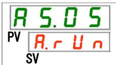
9. [▲]キー及び[▼]キーで下表から循環液吐出温度低下の切り替えを選択し「SEL」キーで確定してください。
