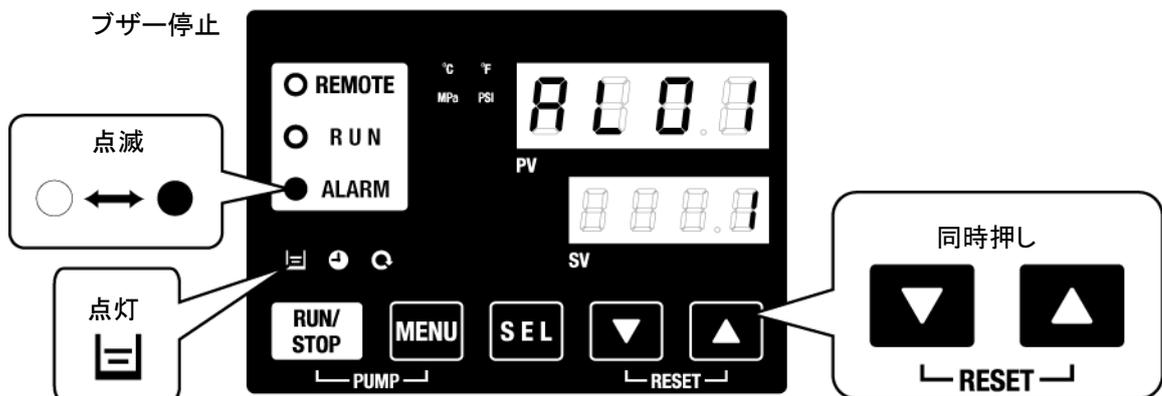
※AL01 タンク液面低下の場合のみ[≡]ランプが点灯します。
