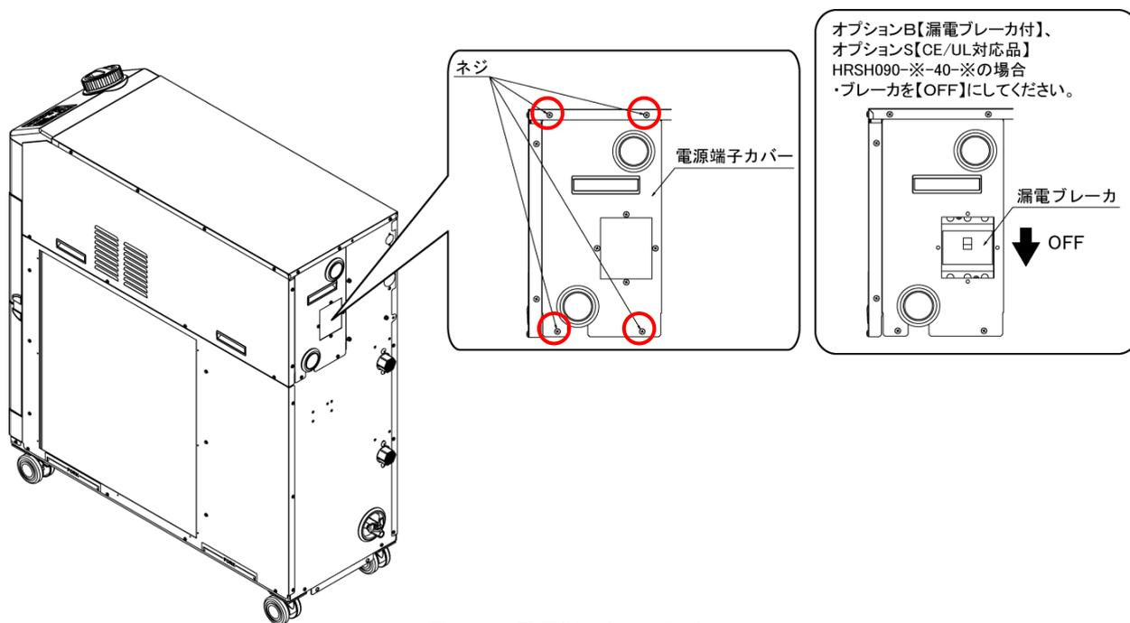
図 3-8 電源端子カバー取外し
