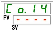
28. [▲]キー及び[▼]キーで下表から通信範囲(簡易通信プロトコル)を選択し「SEL」キーで確定してください。
