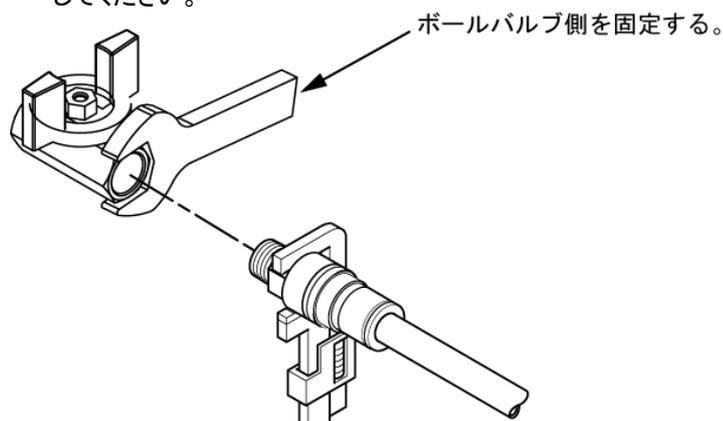
図 8-5 ドレン口への配管接続方法
