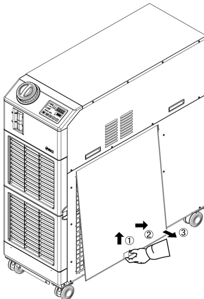
図 8-1 防塵フィルタ取外し
