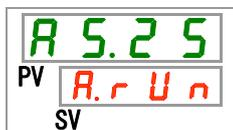
**39.** [▲] キー及び [▼] キーで下表から循環液吐出圧力センサ異常の切り替えを選択し「SEL」キーで確定してください。
