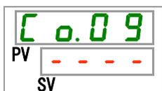
18. [▲]キー及び[▼]キーで下表から BCC(簡易通信プロトコル)を選択し「SEL」キーで確定してください。
