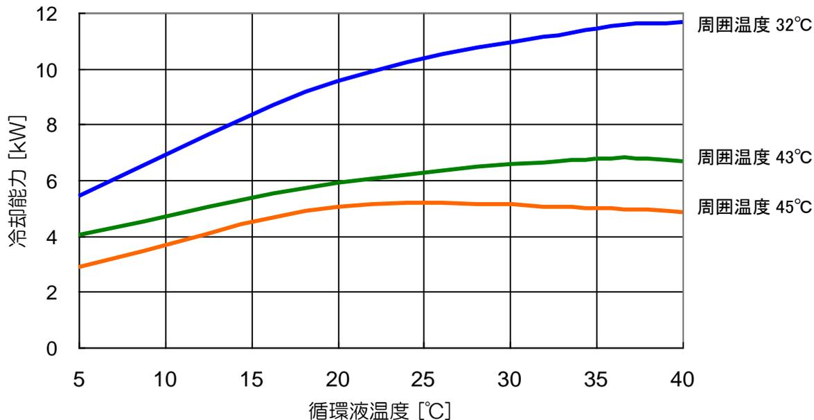
図 9-7 冷却能力(HRS090-A※-20-※)
