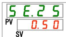
5. [▲]キー及び[▼]キーで下表の様に吐出圧力を設定し「SEL」キーで確定してください。
