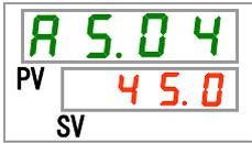
7. [▲]キー及び[▼]キーで循環液吐出温度上昇の検出温度を設定し「SEL」キーで確定してください。
