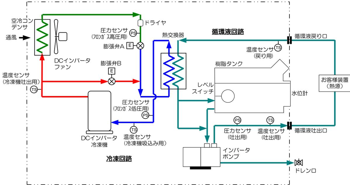
図 9-5 フロー図(HRSH090-A※-20/40-※)
