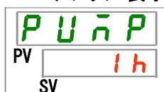
本製品のポンプ動作積算時間を表示します。表示は下表を参照してください。
