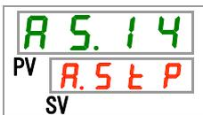
27. [▲]キー及び[▼]キーで下表から接点入力信号 2 検知の切り換えを選択し「SEL」キーで確定してください。
