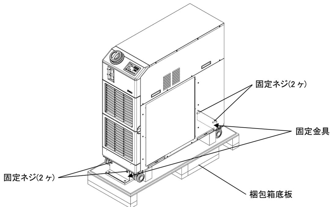
図 3-5 固定金具および固定ネジ
