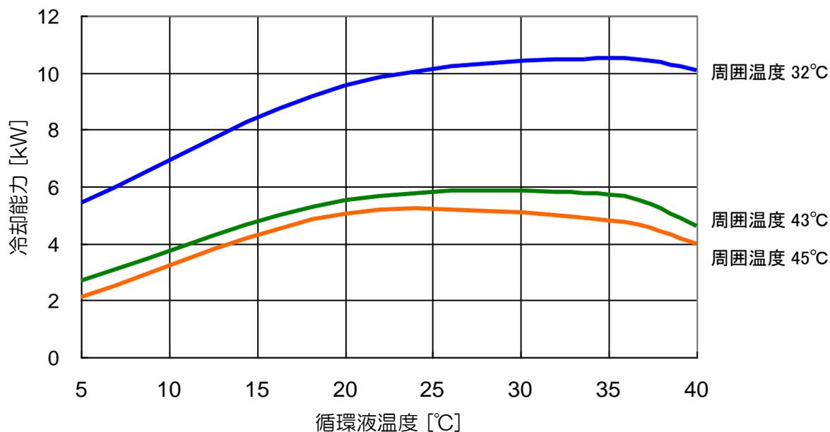
図 9-8 冷却能力(HRS090-A※-40-※)
