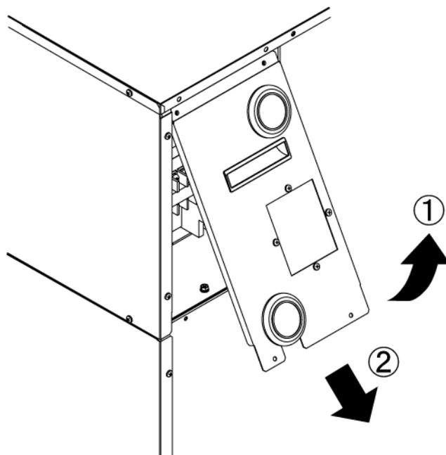
図 3-9 電源端子カバー取外し
