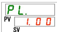
本製品の冷媒回路低圧側の圧力を表示します。
