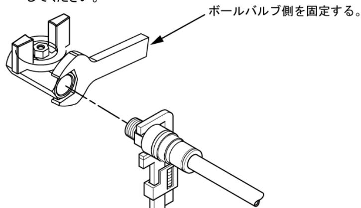
図 3-19 ドレン口への配管接続方法
