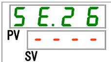
7. [▲]キー及び[▼]キーで下表の様に吐出圧力を設定し「SEL」キーで確定してください。
