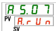
**13.** [▲]キー及び[▼]キーで下表から循環液吐出圧力上昇の切り替えを選択し「SEL」キーで確定してください。
