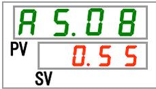
15. [▲]キー及び[▼]キーで循環液吐出圧力上昇の検出圧力を設定し「SEL」キーで確定してください。
