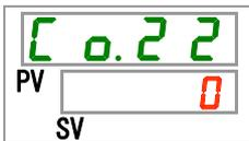
44. [▲]キー及び[▼]キーで接点入力信号 2 OFF 検出タイマの時間を設定し「SEL」キーで確定してください。
