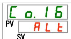
**32.** [▲]キー及び[▼]キーで下表から接点入力信号1形態を選択し「SEL」キーで確定してください。
