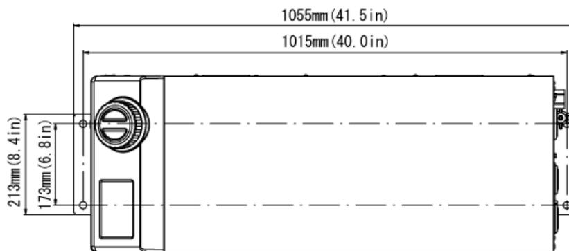
図 9-4 アンカーボルト取り付け位置
