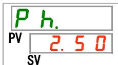
本製品の冷媒回路高圧側の圧力を表示します。
