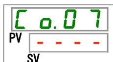
**14.** [▲]キー及び[▼]キーで下表からスレーブアドレス(簡易通信プロトコル)を選択し「SEL」キーで確定してください。
