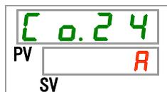
**48.**[▲]キー及び[▼]キーで下表から接点出力信号1動作を選択し「SEL」キーで確定してください。
