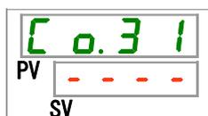
**62.** [▲]キー及び[▼]キーで下表から接点出力信号3選択アラームを選択し「SEL」キーで確定してください。
