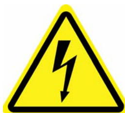
図 1-2 高電圧部に関する危険警告ラベル
