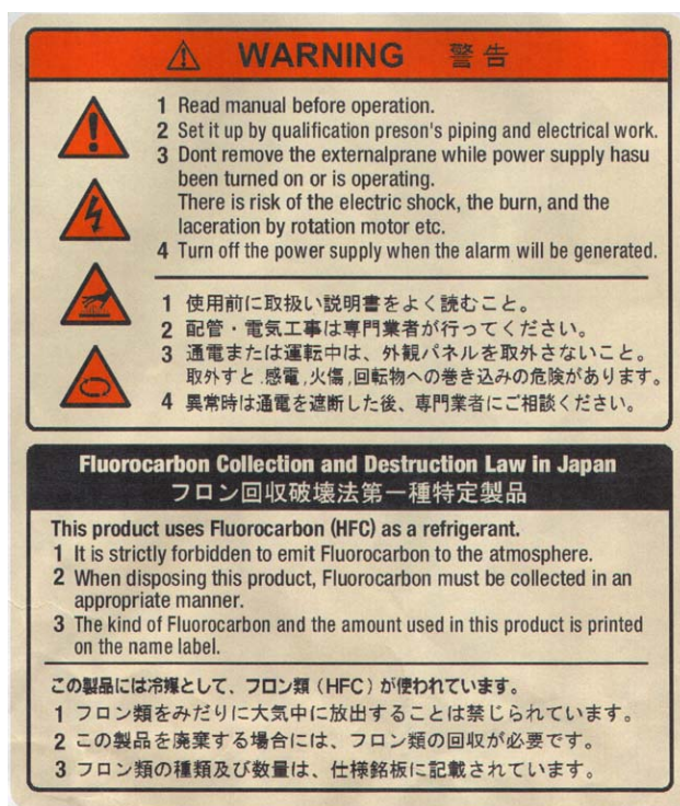
図 1-1 前面パネル危険警告ラベル
