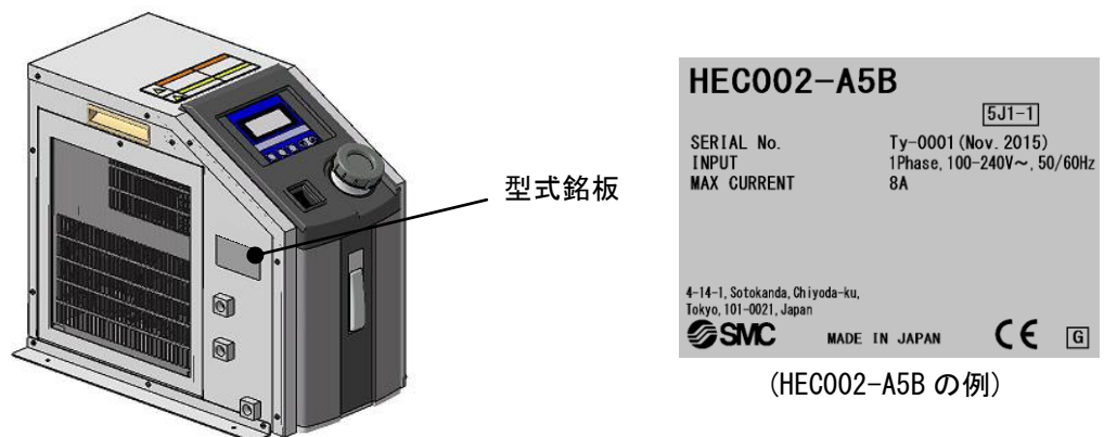
図4-1 サーモコンの型式銘板貼付位置
