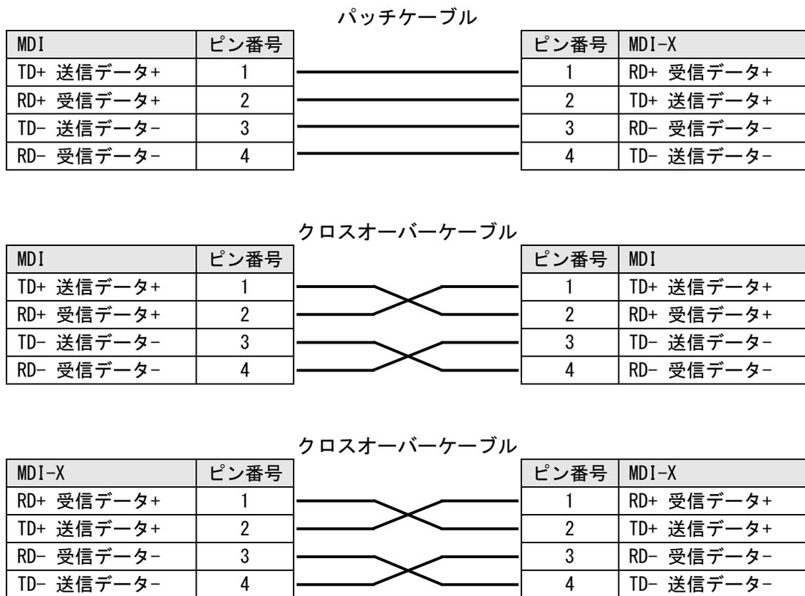
図. 2-3 パッチケーブルとクロスオーバーケーブルの配線例
