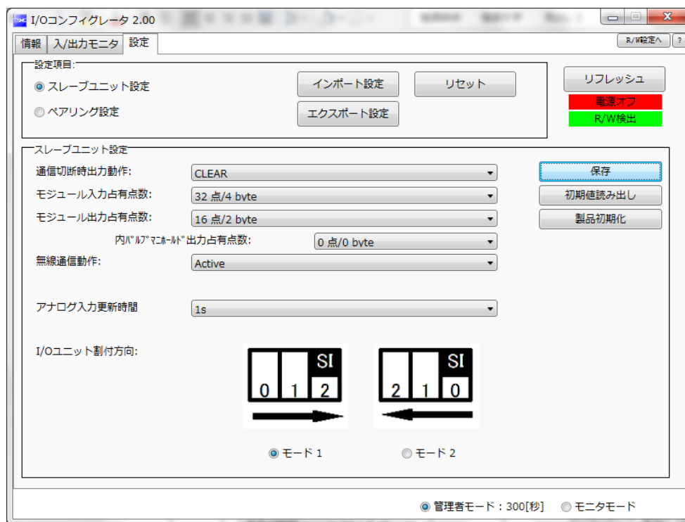
スレーブユニット設定完了後の画面表示 (無線スレーブ②)
