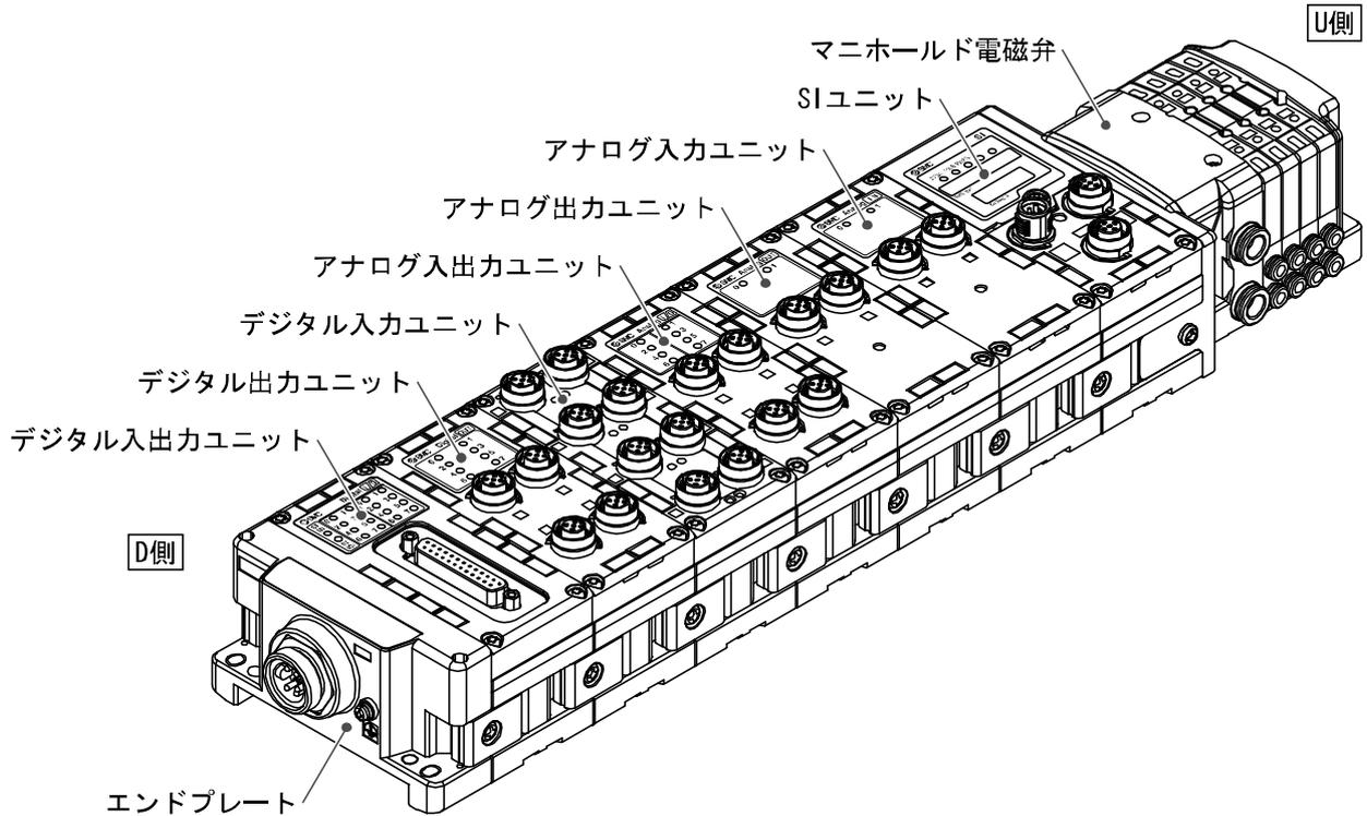
SI ユニット：フィールドバス通信とマニホールド電磁弁の ON/OFF 出力を行います。
