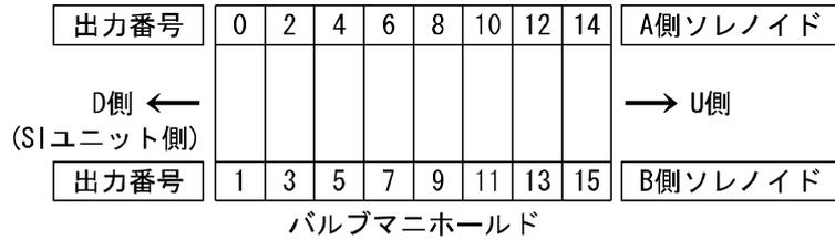
※：標準仕様のマニホールド配線はダブルソレノイド用となり(“ダブル配線仕様”)、出力番号はA側→B側の順で割付けられます。搭載バルブがシングルソレノイドの場合、B側出力は空きとなります。(図a参照)
