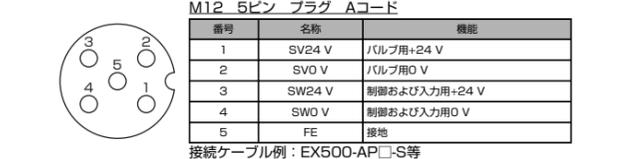
SW電源は、入力ブロックに接続したセンサに供給されます。この時、ユニット内部で最大1 Vの電圧降下がありますので、電圧降下を考慮してセンサの選定を行ってください。どうしてもセンサに24 Vを供給する必要がある場合、実負荷状態でセンサの入力電圧が24 VになるようにSW電源電圧を少し上げる必要があります。(SW電源の許容電圧範囲は19.2 V~28.8 V)
