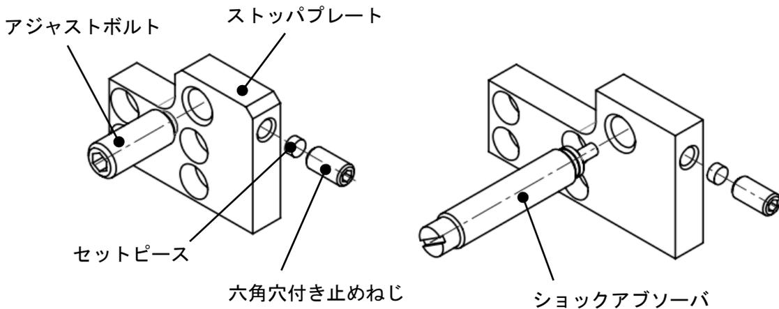
注) 六角穴付き止めねじは、アジャストボルト（ショックアブソーバ）が調整できるように、仮締め状態で取り付けてください。
