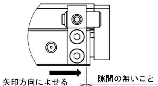
注) ストップブロック取付けの際には、矢印方向によせた状態でボディとすきまが無い様に取付けてください。
