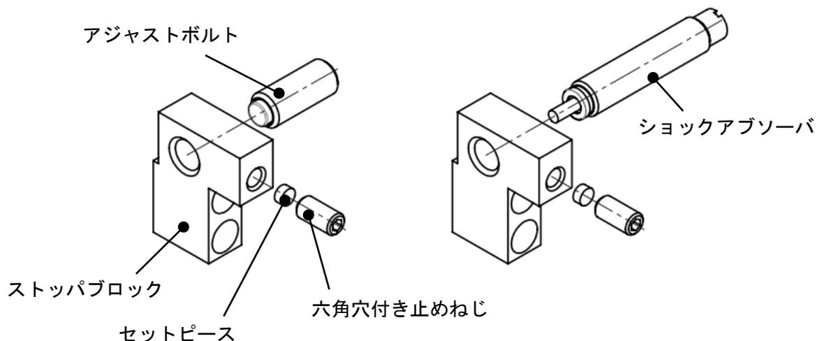
注) 六角穴付き止めねじは、アジャストボルト（ショックアブソーバ）が調整できるように、仮締め状態で取り付けてください。
