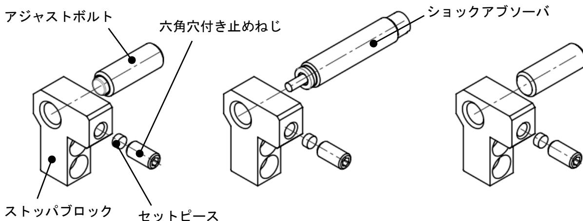
注) 六角穴付き止めねじは、アジャストボルト（ショックアブソーバ）が調整できるように、仮締めの状態で取り付けてください。
