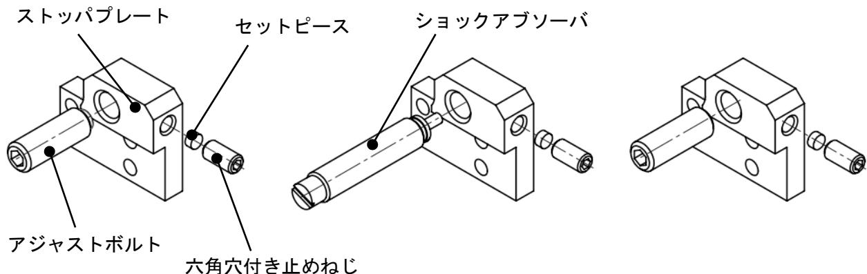
注) 六角穴付き止めねじは、アジャストボルト（ショックアブソーバ）が調整できるように、仮締めの状態で取り付けてください。
