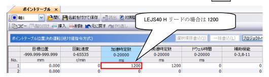
\*4: 原点復帰の加速時定数(msec)はポイントテーブル番号 1 の加速時定数を使用します。上図の箇所に推奨値を設定してください。
