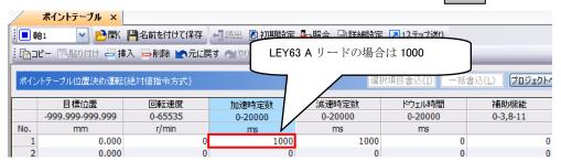
\*5:原点復帰の加速時定数(msec)はポイントテーブル番号 1 の加速時定数を使用します。上図の箇所に推奨値を設定してください。
