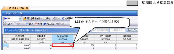
\*5:原点復帰の加速時定数(msec)はポイントテーブル番号 1 の加速時定数を使用します。上図の箇所に推奨値を設定してください。
