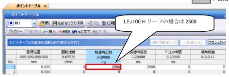
\*4: 原点復帰の加速時定数(msec)はポイントテーブル番号 1 の加速時定数を使用します。上図の箇所に推奨値を設定してください。
