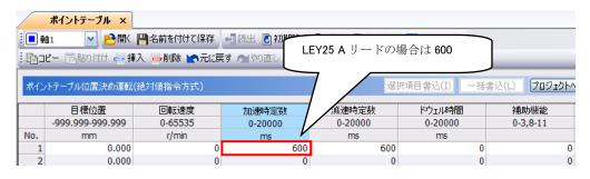
\*5:原点復帰の加速時定数(msec)はポイントテーブル番号 1 の加速時定数を使用します。上図の箇所に推奨値を設定してください。
