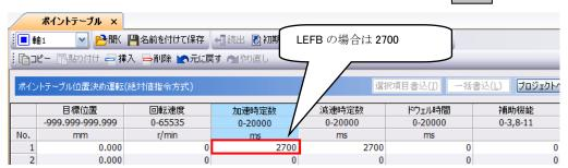
\*4: 原点復帰の加速時定数(msec)はポイントテーブル番号 1 の加速時定数を使用します。上図の箇所に推奨値を設定してください。
